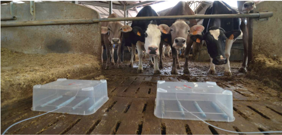
Abbildung 1: Beispiel einer Kammermessung in einen Praxisstall (Quelle: Chiumenti et al., 2018).
